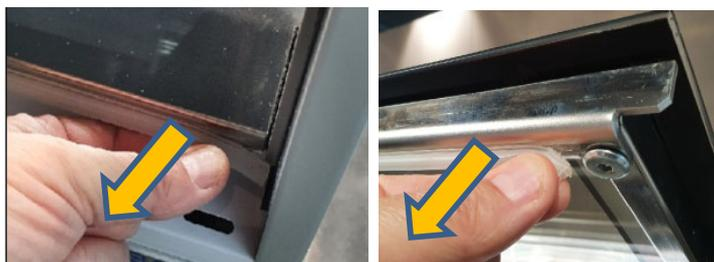
Inserire la nuova guarnizione nella stessa posizione facendo pressione per garantire una adeguata presa del collante prima di richiudere i vetri.
