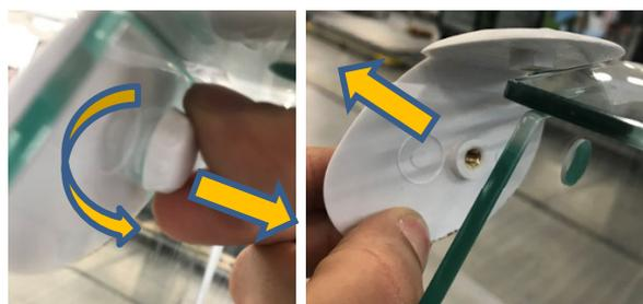
Rimuovere la guarnizione danneggiata e pulire accuratamente la superficie da ogni possibile residuo di colla.
