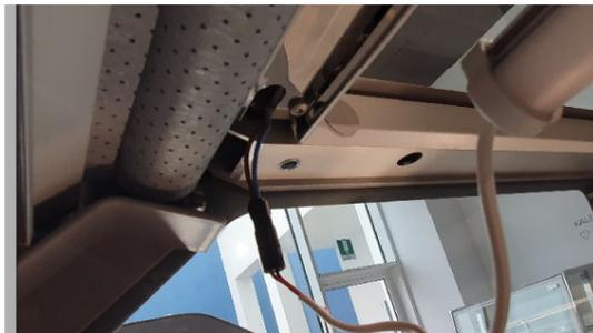
Scollegare la lampada per la sostituzione avendo cura di rimontarla correttamente con operazioni inverse.
